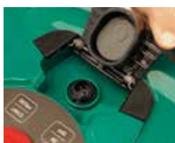
Gniazdo ładowania Charging Point
