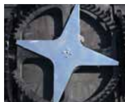
Nóż z osłoną i systemem usuwania resztek trawy Blade and protection with filtering system for grass disposal
