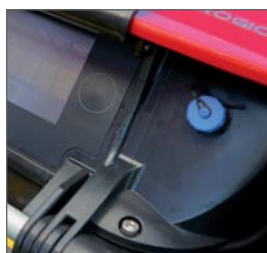
Czujnik deszczu, który może być wyłączony Rain sensor that can be turned off
