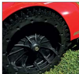
Samoczyszczące się koła zębate Self-cleaning toothed wheel
