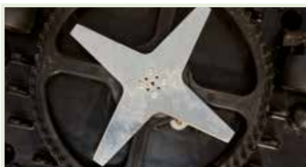
Oslona noża z filtrem ułatwiającym usuwanie pozostałości trawy Blade protection with filtering system for grass disposal
